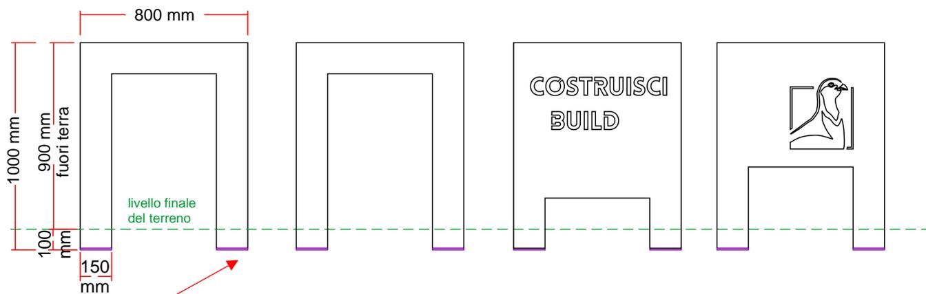
*in colore violetto, elementi per il fissaggio alla piastra di base e per l'appoggio a terra*
